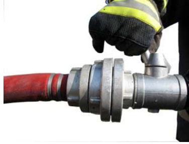
C Tipi rekora adaptör kullanılarak B tipi lans bağlanması
