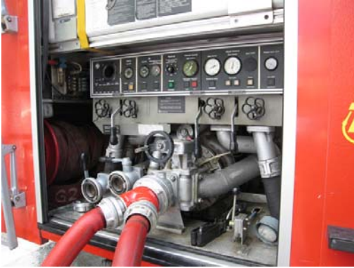
Redüksiyon kullanarak araçlara su takviyesi yapılması
