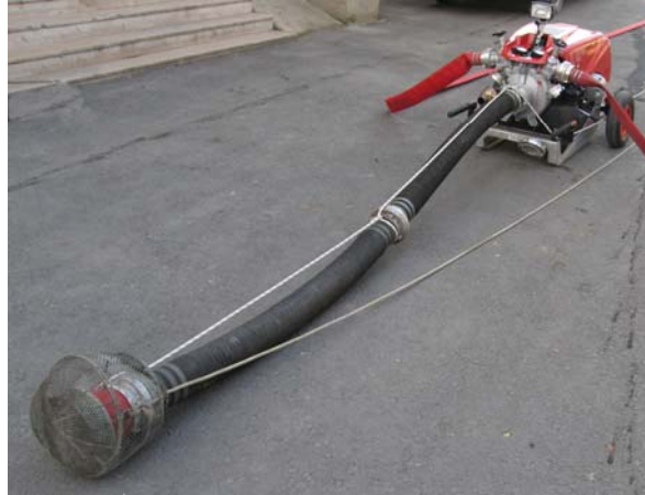
Ala süzgeci + Ala sepeti+ Ala ve Klepe ipinin kombine uygulanması
