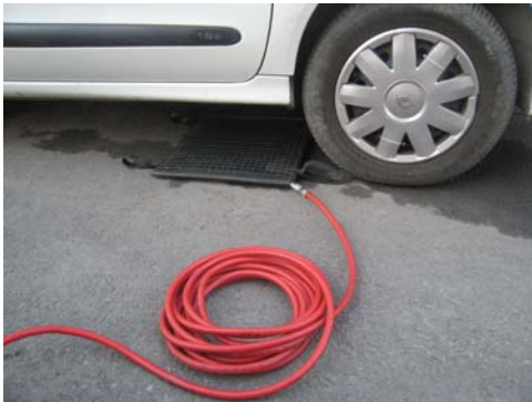
Hava Yastığı yerleştirilir
